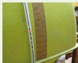
Esempio di scala di lettura funzionante dopo sostituzione a seguito del controllo funzionale
