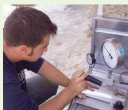
Verifica funzionalità manometro
