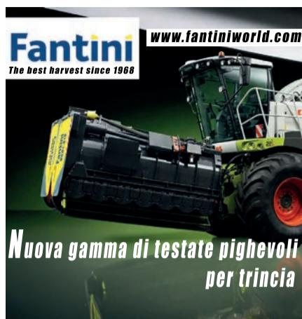
Entrambe sono caratterizzate dal montare enormi coclea flottanti di oltre 900 millimetri di diametro, sistema di taglio europeo con alberi di sicurezza, trasmissione a cinghia a 5 gole per partenze "dolci" e di sicurezza in caso di urto, frizione su cardani per una rapida sostituzione, aggancio flottante, pattini regolabili in Hardox e altro ancora.
